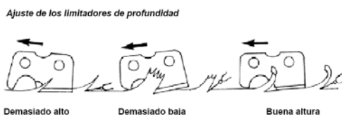
Figura 8. Límites de profundidad de los dientes de la cadena de la motosierra.
