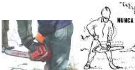
Figura 4. Forma correcta de arrancar la motosierra (izquierda) y forma incorrecta (derecha).
