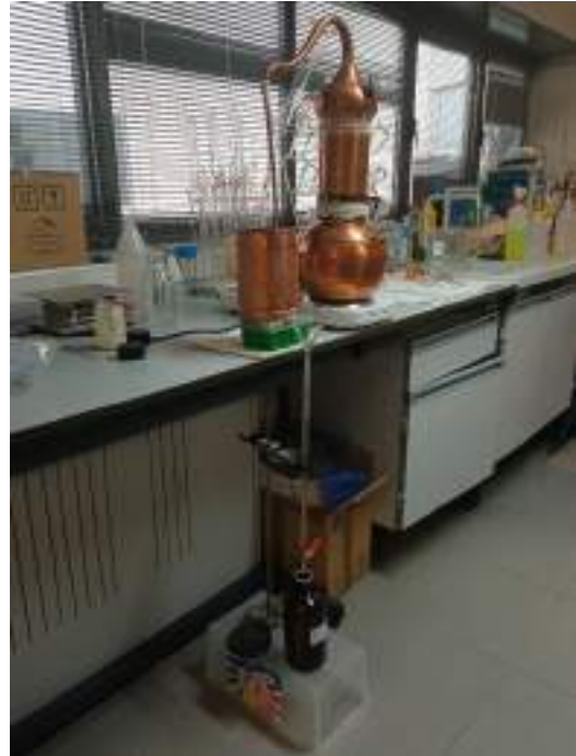
Figura de la izquierda: Equipo destilación en cobre. Figura de la derecha: Proceso de destilación y separación del hidrolato y aceite esencial.
