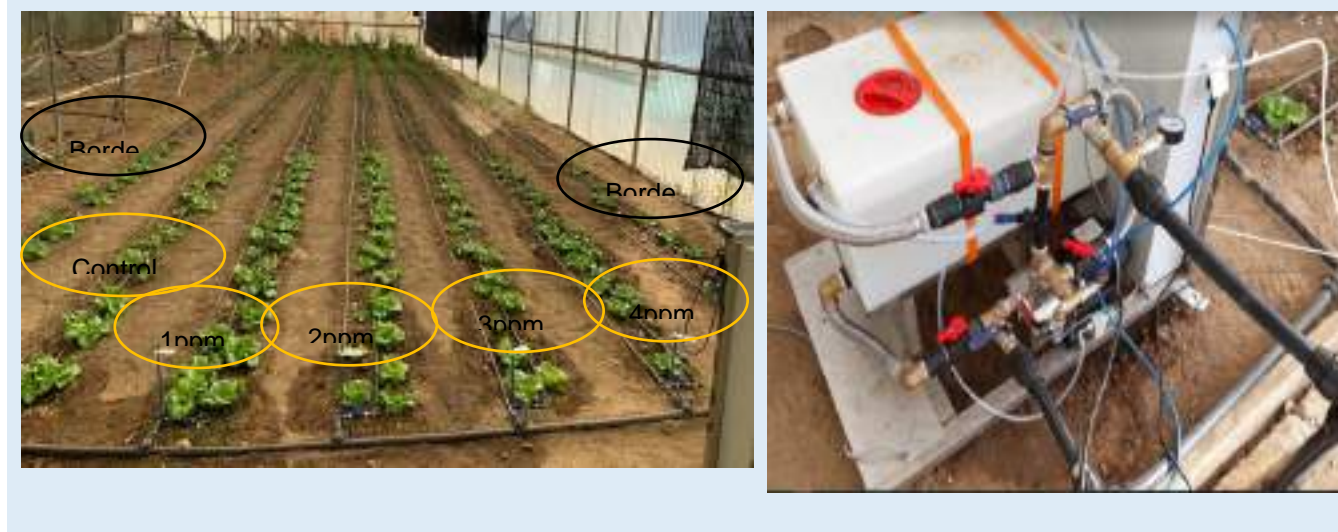
Figura 43. Conexión del generador de ozono al sistema de riego del invernadero
