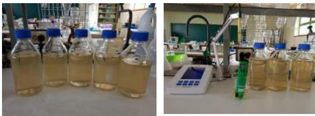
Figura 33. Equipos utilizados para medir el potencial Redox y la conductividad eléctrica del agua a distintas concentraciones de sal y ozono
