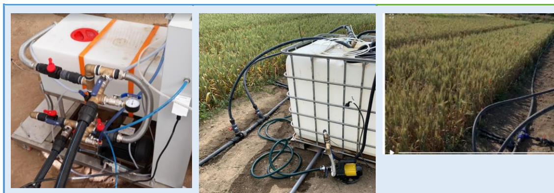
Figura 42. Conexiones equipo de ozono a los ramales fijos de riego de Santana
