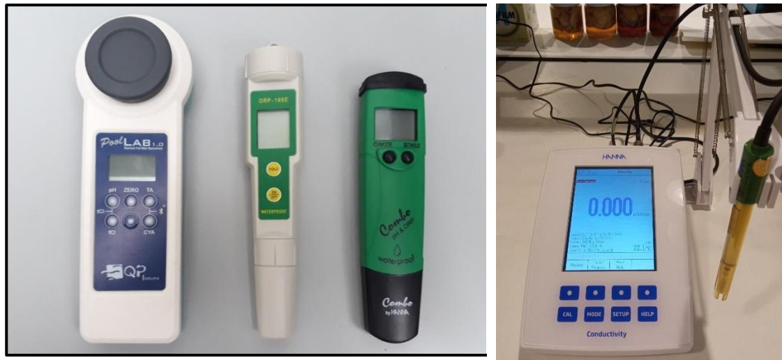
Figura 32. Equipos de medida de ozono y conductividad eléctrica
