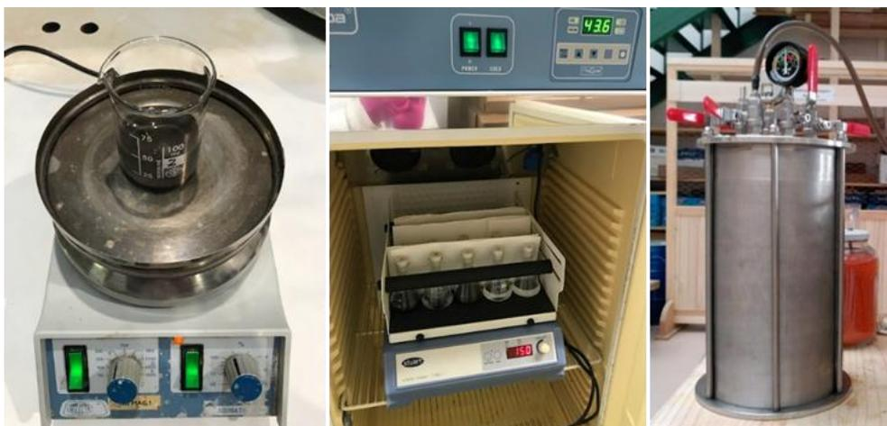
Pruebas de absorción/adsorción de los materiales en las matrices carbonosas, (izq.) contacto en solución acuosa con agitación, (centro) con un incremento en la temperatura y (der.) con un incremento en la presión.
